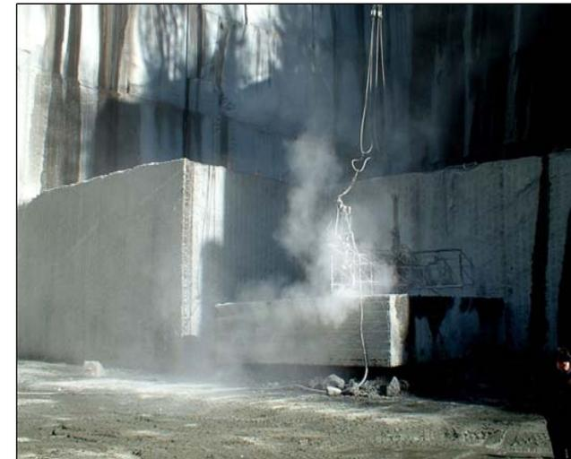
Tra le cave indagate, il 50% circa impiega un sistema misto con miccia detonante e polvere nera; il 38% circa un sistema misto a miccia detonante e filo diamantato; il 7% un metodo misto a miccia detonate, filo diamantato e polvere nera, mentre solo il 5% fa uso della sola miccia detonante.
